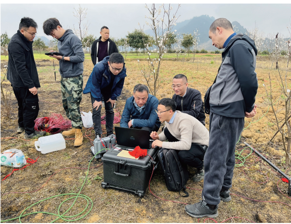
104地质大队物化探中心党员在贵定项目布设Aether大地电磁测深剖面
